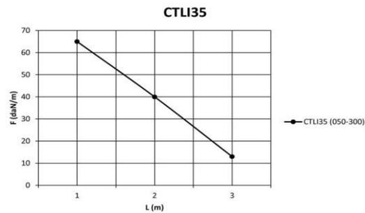
Werte aus Belastungsprüfungen nach der Norm IEC 61537, Prüftyp III.
