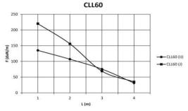
Werte aus Belastungsprüfungen nach der Norm IEC 61537, Prüftyp III. Verbindung auf 1/5xL von erster und letzter Stütze, Endspannweite = 0.8xL, CLL60-(I)J-PG
