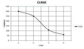
Werte aus Belastungsprüfungen nach der Norm IEC 61537, Prüftyp II. Keine Verbindung bei erster und letzter Überspannung, Endspannweite = 0.8xL, CL60-J-DG
