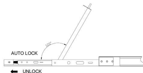
De seguida, abra o painel frontal. O painel frontal contendo o LCD apresenta um ângulo de abertura máximo em funcionamento de 120 graus.
