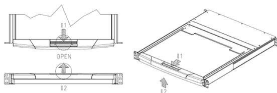
Deslize a plataforma de controlo para o exterior do rack e pressione o fecho na parte frontal do KVM.
