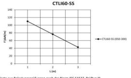
Werte aus Belastungsprüfungen nach der Norm IEC 61537, Prüftyp III. Verbindung auf 1/5xL von erster und letzter Stütze, Endspannweite = 0.8xL, 5xBN06-10-SS
